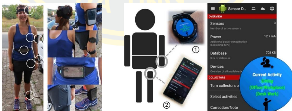
ภาพที่ 22 การติดตั้งอุปกรณ์บนตำแหน่งต่างๆ ของร่างกาย และแอปพลิเคชันในการเก็บข้อมูลของฐานข้อมูลกิจกรรม RealWorld
