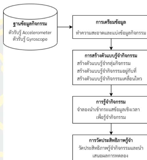
ภาพที่ 4 กรอบแนวคิดวิธีการรู้จำกิจกรรม Smartwatch-based Physical Activity Recognition (SPAR)
